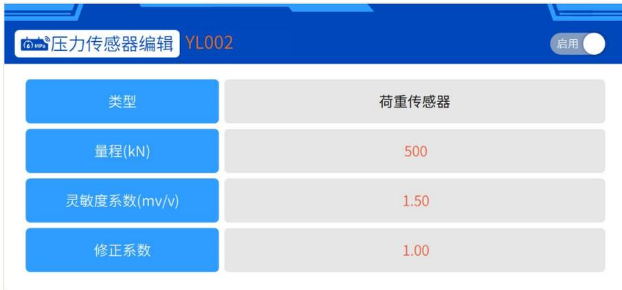
图 2-26 荷重传感器编辑界面
