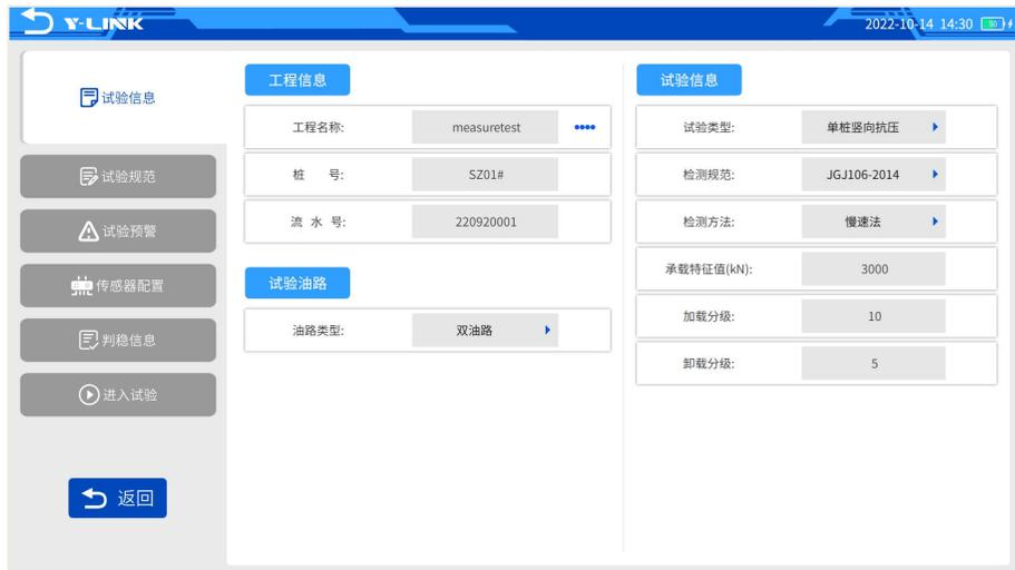
图 3-2 试验参数设置界面
