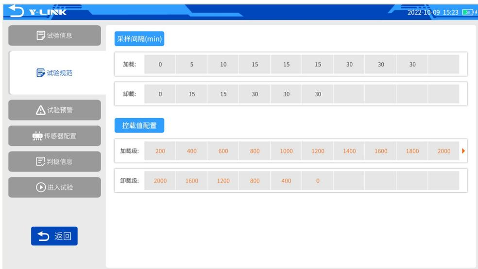
图 2-7 试验参数设置界面
