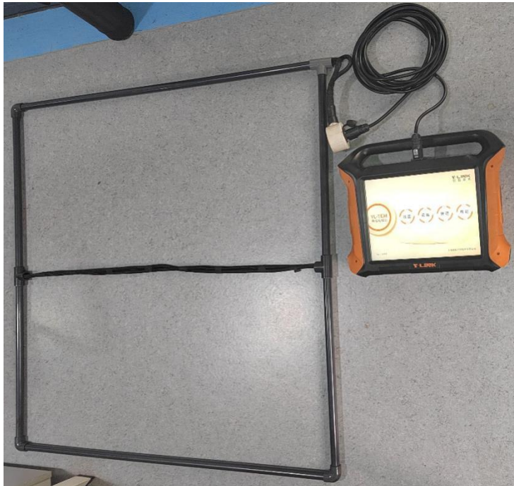
图 4-3 瞬变电磁仪系统连接示意图
