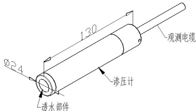
当被测水荷载作用在渗压计上，将引起感应膜板的变形，其变形带动振弦转变成振弦应力的变化，从而改变振弦的振动频率。电磁线圈激振振弦并测量其振动频率，频率信号经电缆传输至读数装置，即可测出水荷载的压力值。同步测量埋设点的温度值。
