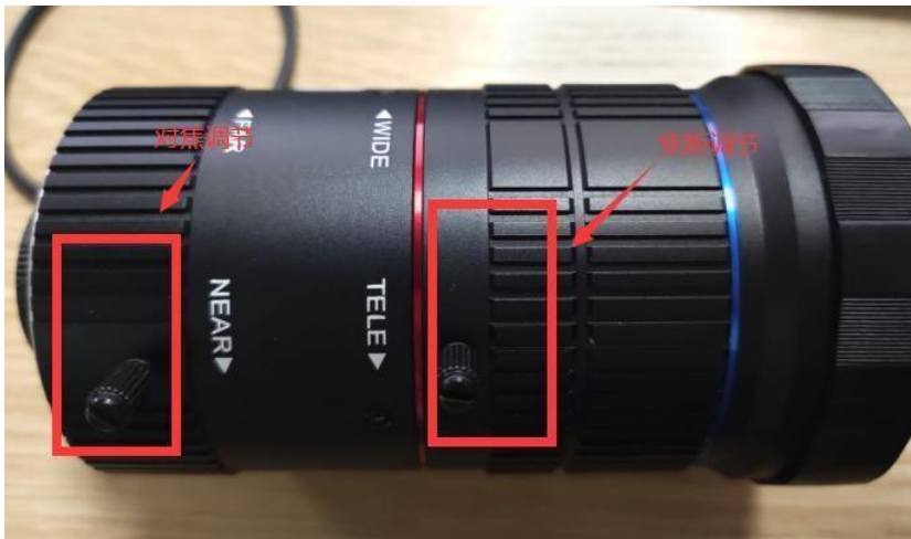
( 2 ) 16mm-70mm 焦距可调镜头 ( 可调节焦距与对焦环 , 光圈不可调 )
