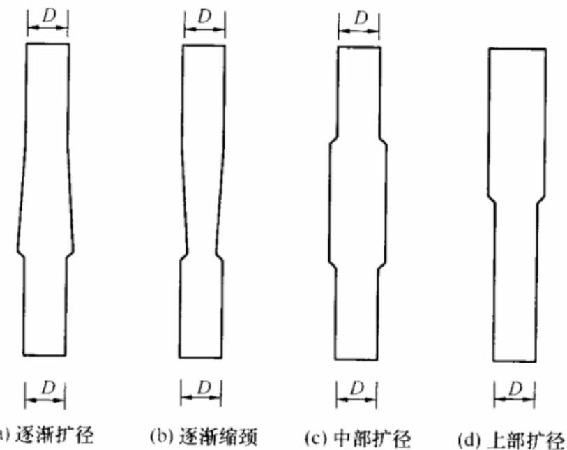
图 7 混凝土灌注桩截面(阻抗)变化示意图
