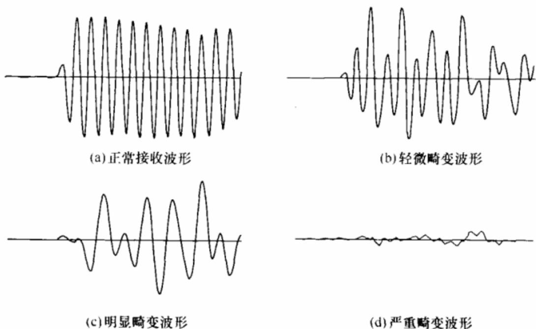
图 13 接收波形畸变程度示意
