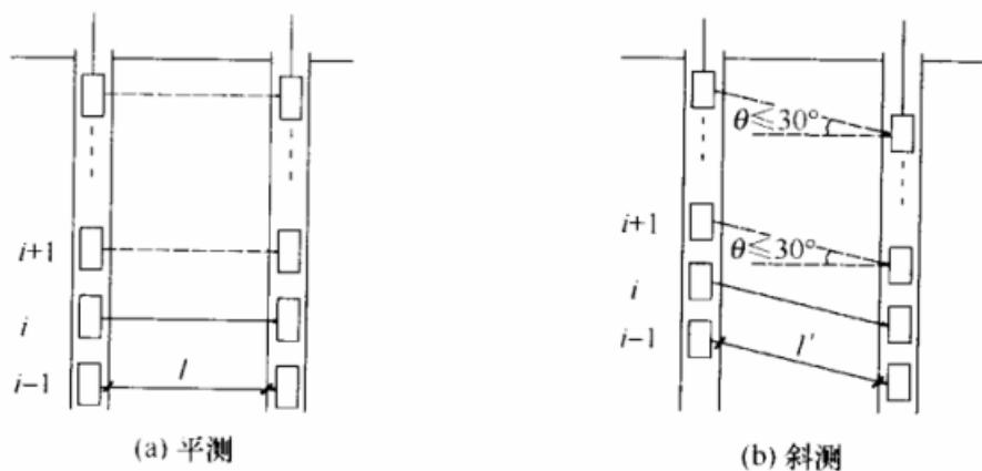
图10.4.2 平测、斜测示意图
