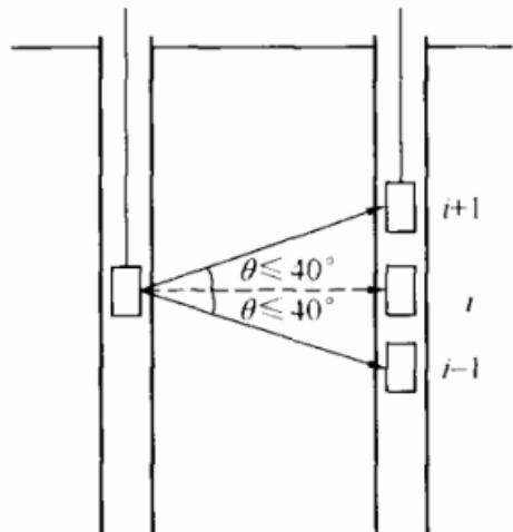
图 10.4.3 扇形扫测示意图
