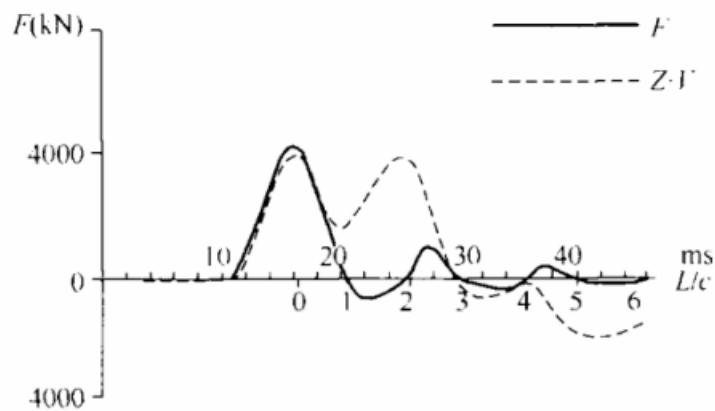
图8 灌注桩高应变实测波形
