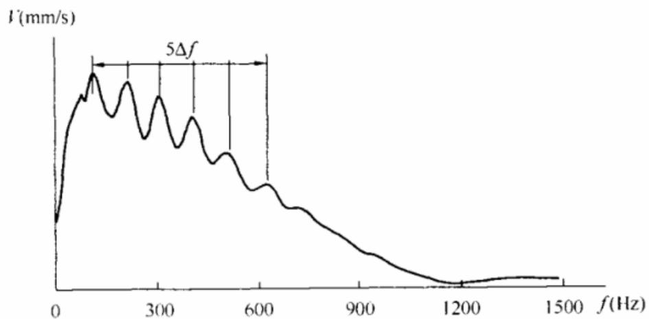
图 3 完整桩典型速度幅频信号特征
