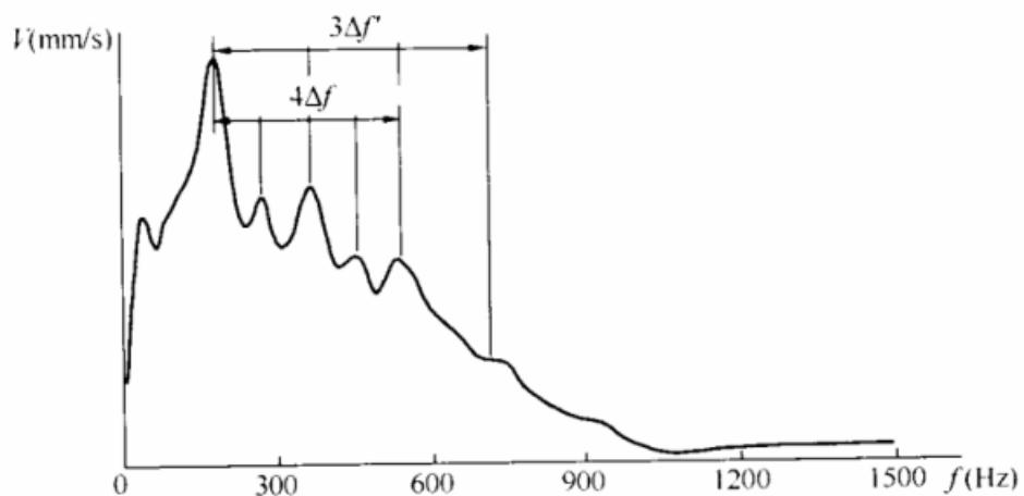
图 5 缺陷桩典型速度幅频信号特征
