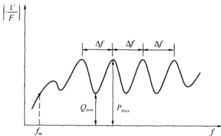
图 6 均匀完整桩的速度导纳曲线图
