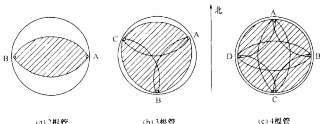
图 10.3.2 声测管布置示意图
