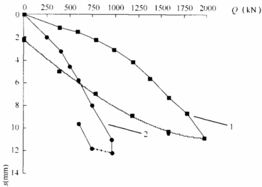
图 9 静载和动载模拟的  $Q-s$  曲线
