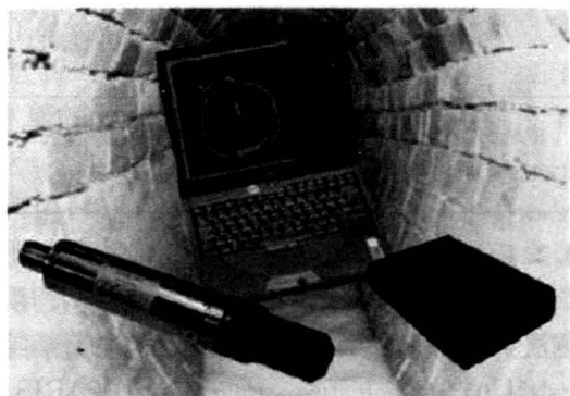
图 1.3-4 声纳检测设备
