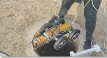
一、调整镜头朝上，抬升支架降到最低，将下井挂钩挂于爬行器吊环上，径直将爬行器提起。
