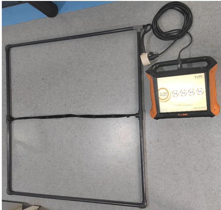
图 4-3 瞬变电磁仪系统连接示意图
