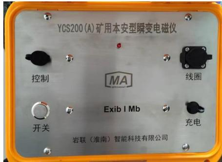
图 4-1 瞬变电磁仪面板结构
