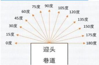
该示意图展示了探测角度的分布。中心是一个标有“迎头 巷道”的矩形。从该矩形中心向外辐射出多条带箭头的射线，分别标注了角度：0度、15度、30度、45度、60度、75度、90度、105度、120度、135度、150度、175度和180度。
