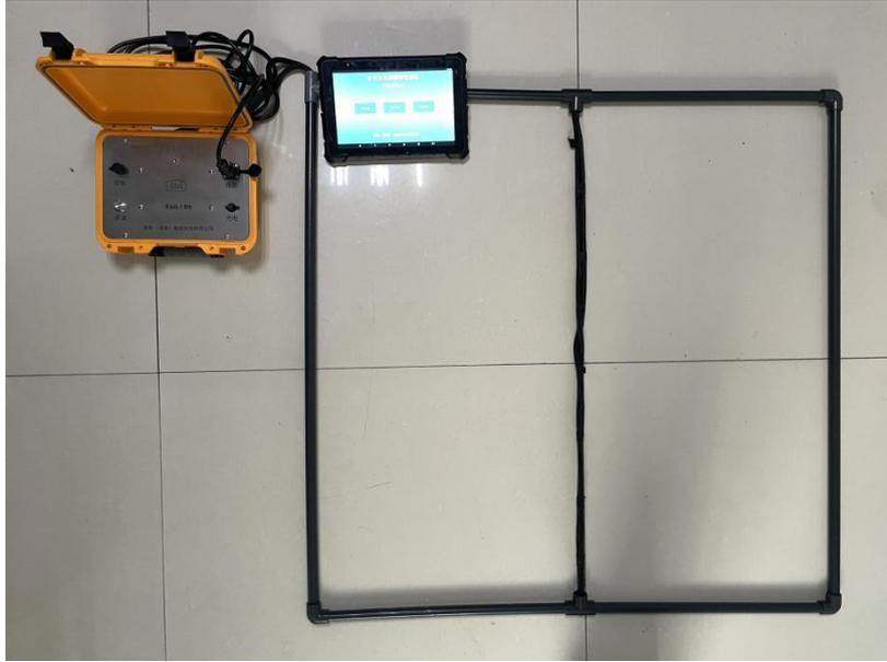
图 4-2 瞬变电磁仪系统连接示意图
