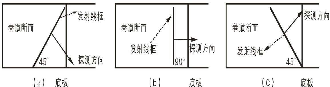
图 2-2 瞬变电磁法探测方向示意图
